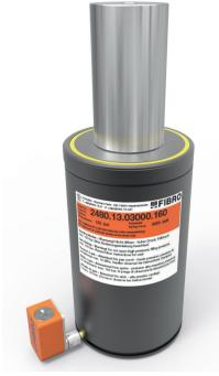
**Objekt der Beobachtung:** Die Sensoren des WPM erfassen permanent den im Inneren solch einer Gasdruckfeder vorhandenen Druck sowie die Temperatur und gleichen die Werte mit zuvor definierten Grenzwerten ab © Fibro
