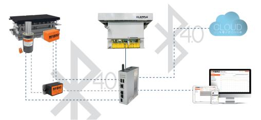
**Transparent, vernetzt:** Struktur des nun erweiterten Überwachungssystems Wireless Pressure Monitoring (WPM) von Fibro © Fibro
